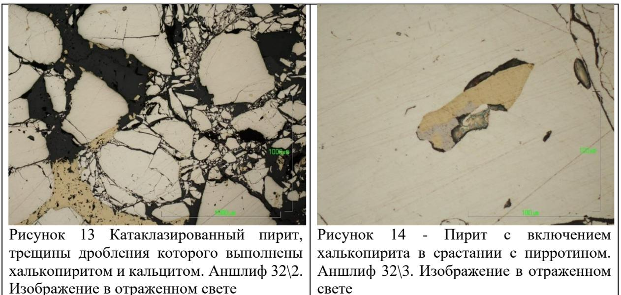
Рисунок 13 Катаклазированный пирит, трещины дробления которого выполнены халькопиритом и кальцитом. Аншлиф 32\2. Изображение в отраженном свете
