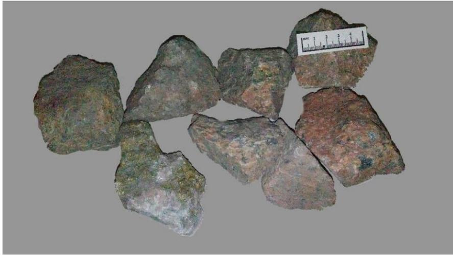
Рисунок 2 (а) - Штуфные образцы гранитов розового и зеленовато-розового цвета массивной текстуры и кристаллическизернистой структуры
